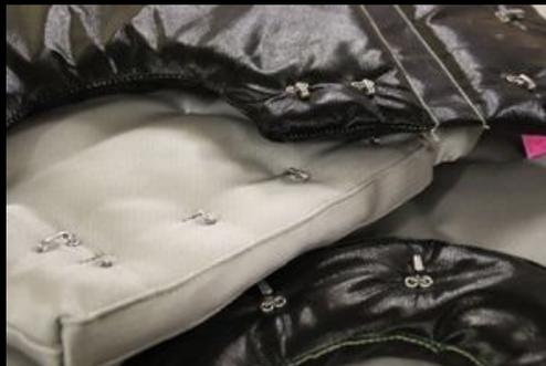
Diese werden aus Hitzeschutzgeweben und entsprechender Hochtemperaturfüllung genäht. Sie werden **passgenau gefertigt**. Damit können heiße, und auch "nur" warme Objekte wie mit einem Maßanzug gedämmt werden.
